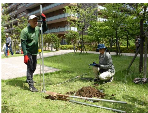
・長谷川式土壤貫入計による土壤硬度調査
