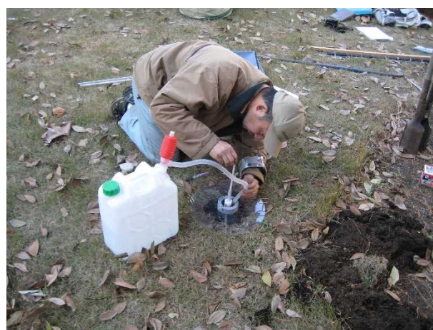
・長谷川式簡易現場透水試験器による透水性調査
